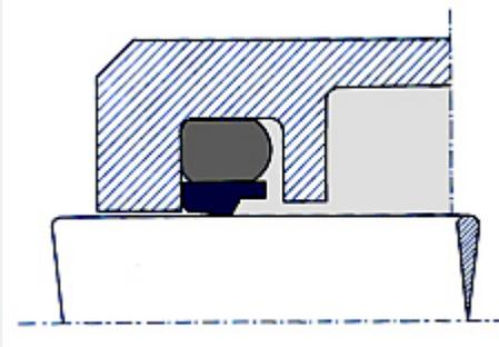
Uno stelo smussato correttamente e la lubrificazione delle superfici facilitano il montaggio.
