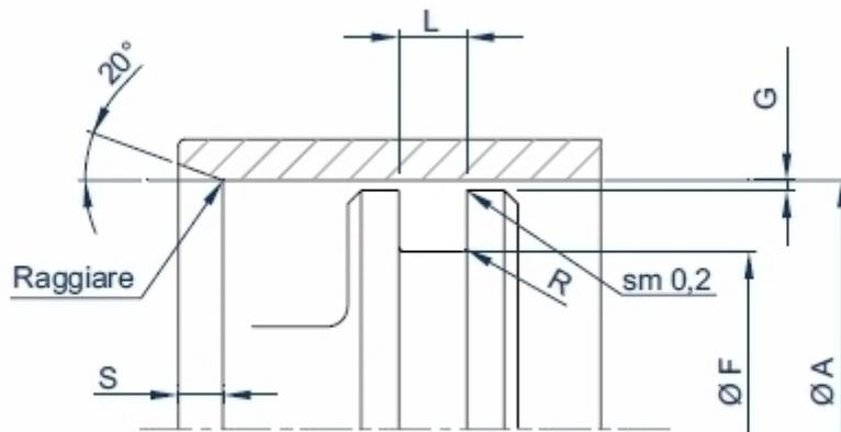
Guarnizioni composite Slipper adatte alle piu' gravose condizioni di impiego ed ai maggiori giochi di accoppiamento, necessita di ricalibrazione se montata in cava chiusa.
