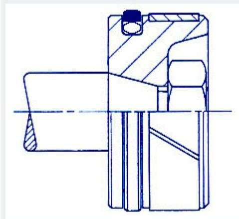
L'assemblaggio in cava chiusa puo' essere effettuato manualmente, tuttavia, l'uso di apposita attrezzatura garantisce l'integrita' dello Slipper e contenuti tempi di inserimento.
