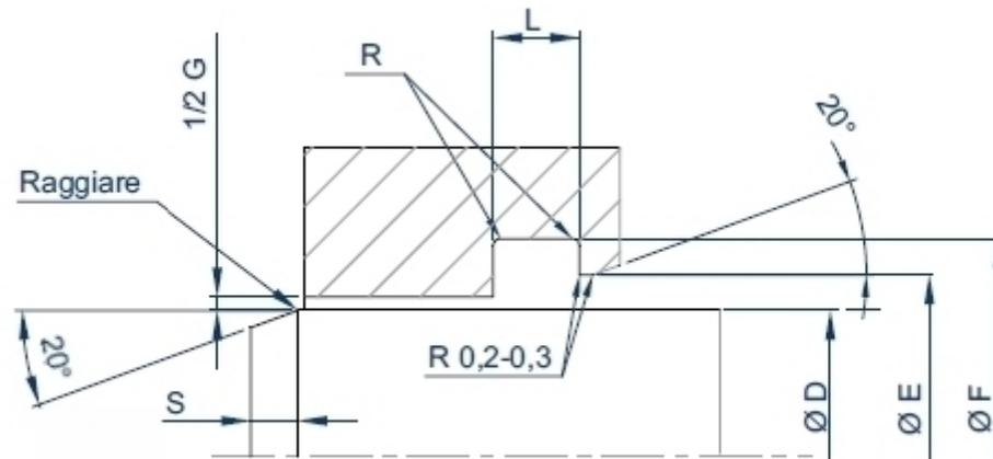
I raschiastelo energizzato **Enerwiper** consiste in un elemento raschiante in Neufon ptfe, oppure PU o UHMW-PE, energizzato da molla inox. Il particolare profilo e la scelta dei materiali ne fanno un componente estremamente affidabile in grado di prevenire la penetrazione di contaminanti solidi e liquidi nella zona di guida e tenuta.
